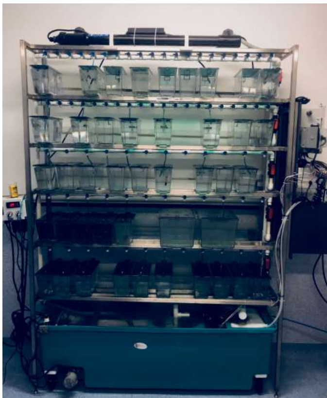
Figura 6. Rack para peces con sistema de aireación continuada y control automático de pH.
