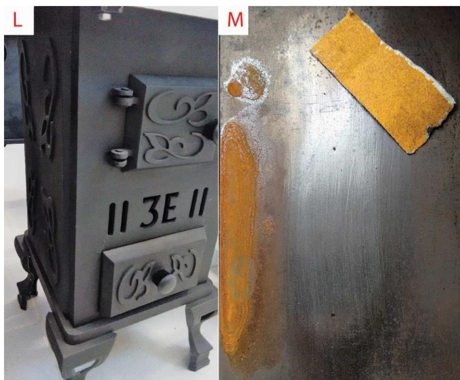
Fonte: L – Fogão à lenha de gabinete com seu corpo revestido de ferro fundido, com aplicação de revestimento para proteção do material; M – Chapa antiga de ferro fundido com áreas oxidadas. Fora lixada em um ponto para atestar sua aparência anterior; Fotografado e adaptado pelo autor, (2017).
