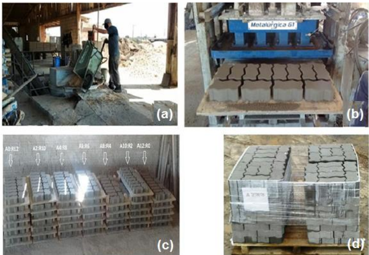
Figura 23 – Etapas de produção dos pavers : mistura (a), moldagem (b), cura (c) e estocagem (d)
