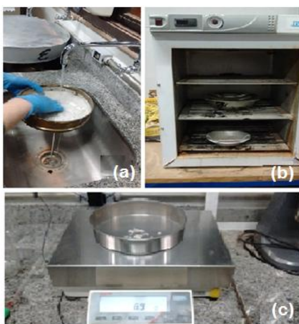
Figura 19 – Etapas da análise de material pulverulento do lodo de gemas
