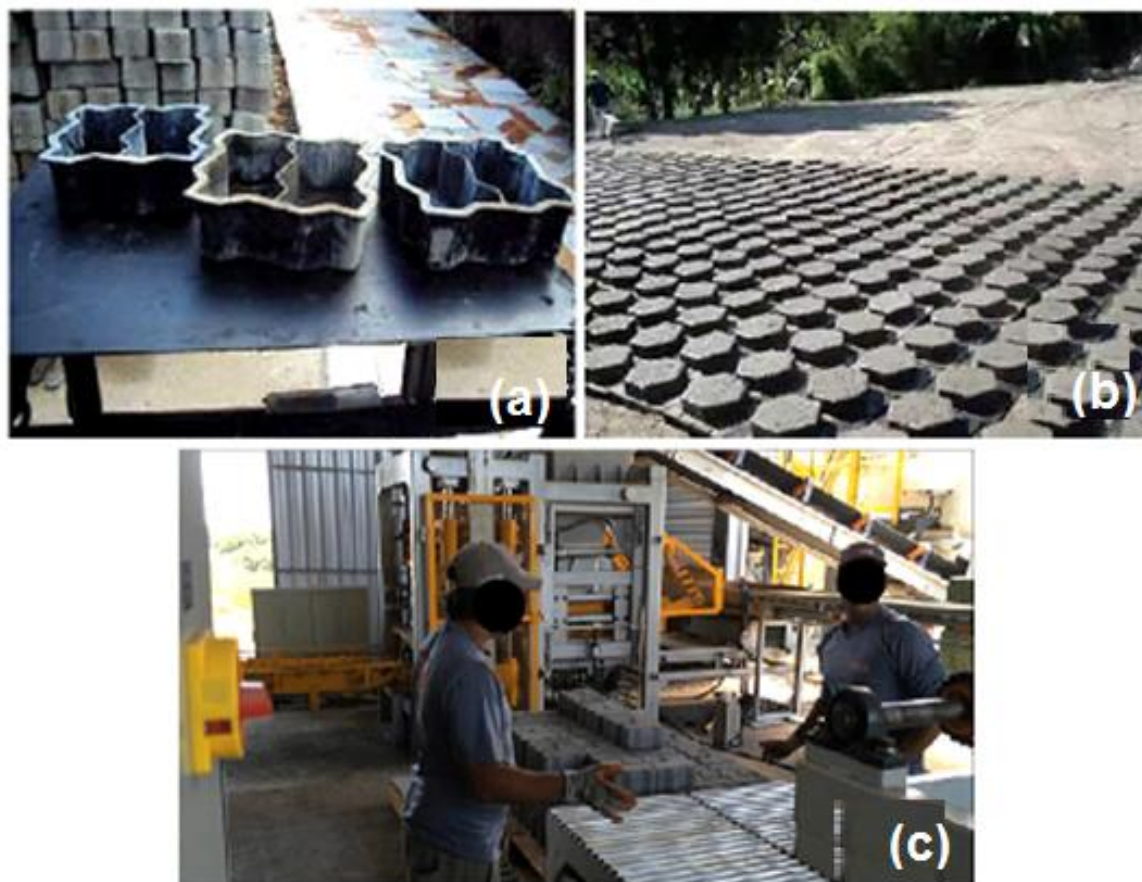
Figura 9 – Sistemas de fabricação de pavers tipo descanso (a), virado (b) e vibro prensado (c).
