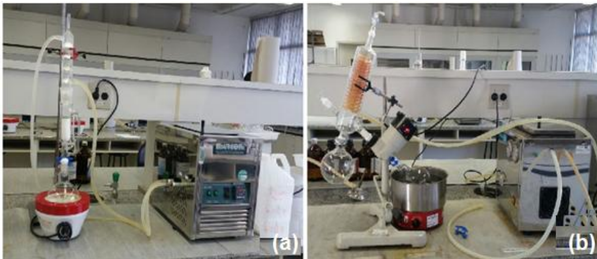
Figura 16 – Sistema de extração Soxhlet (a) e o rotaevaporador (b)
