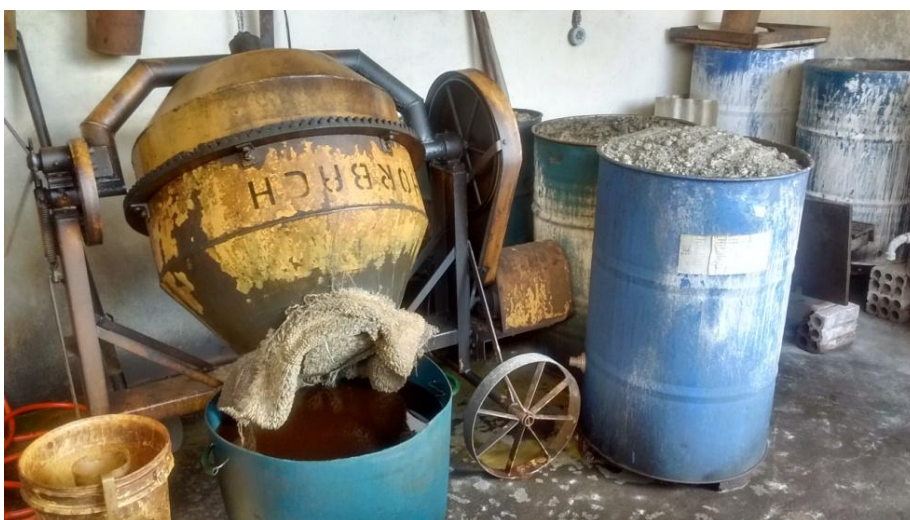
Figura 15 – Processo de retirada do excesso de água do lodo
