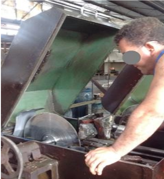
Figura 29 – Serra caixão utilizada no corte das ágatas
