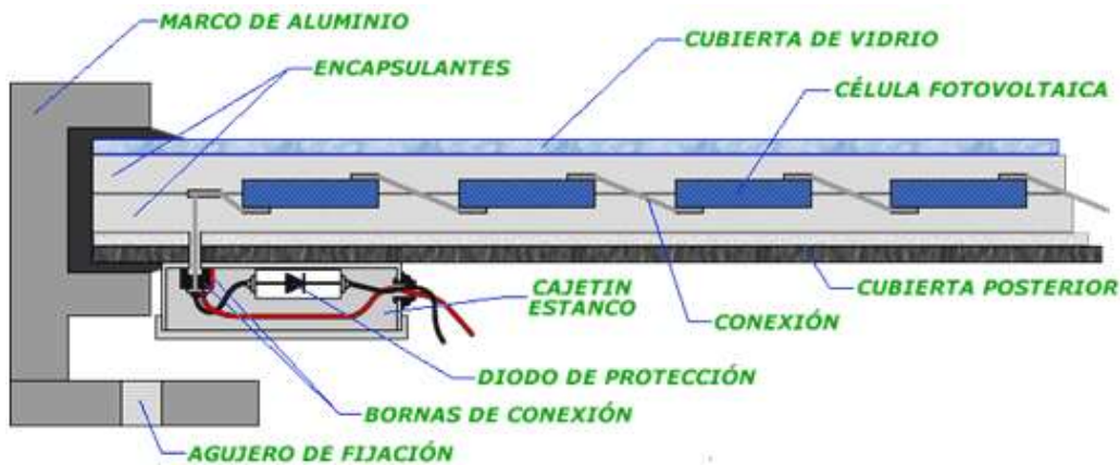
Figura 32: Elementos de un panel fotovoltaico. FUENTE: [29]
