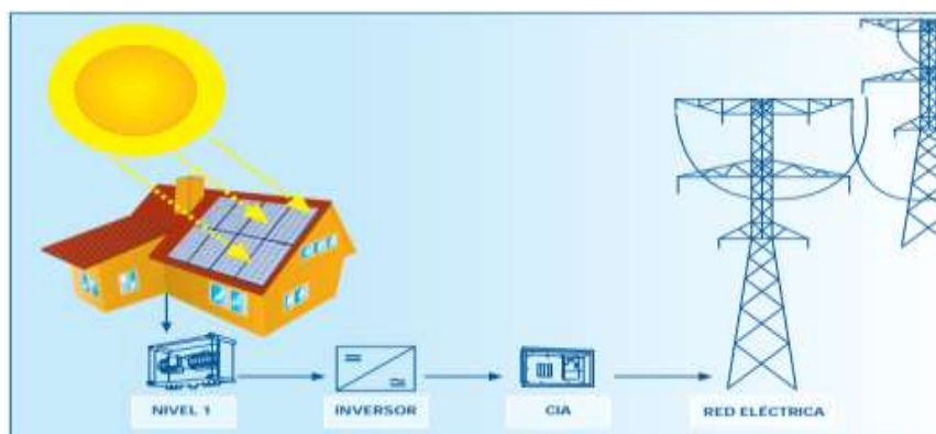
Figura 40: Instalación FV conectada en red. FUENTE: [30]
