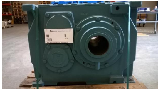
Figura 40. Multiplicadora de la marca Hansen Gear, para turbina Vestas V20.
