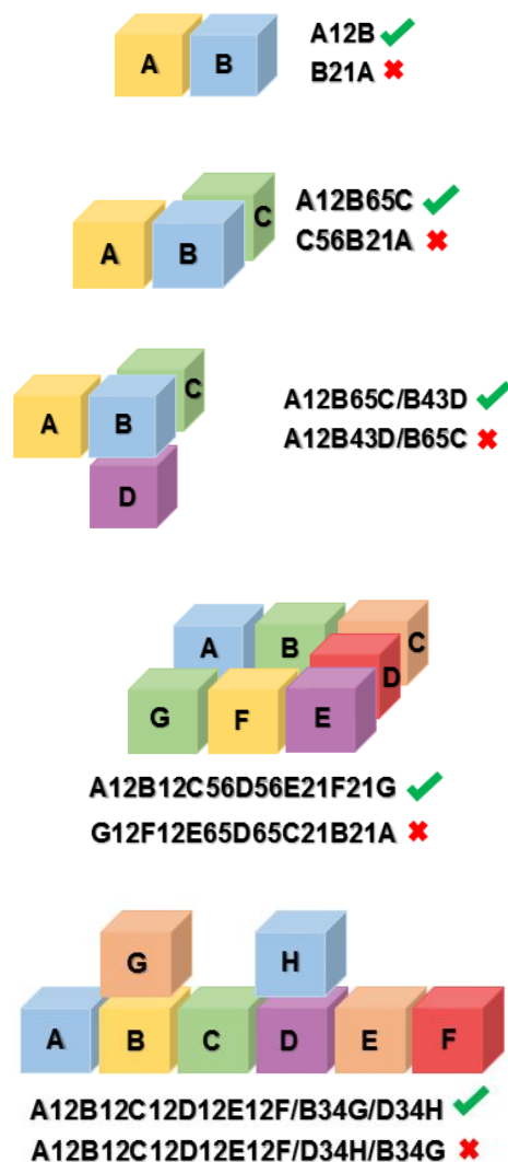
Figura 6: Codificaciones correctas e incorrectas para distintos montajes.
