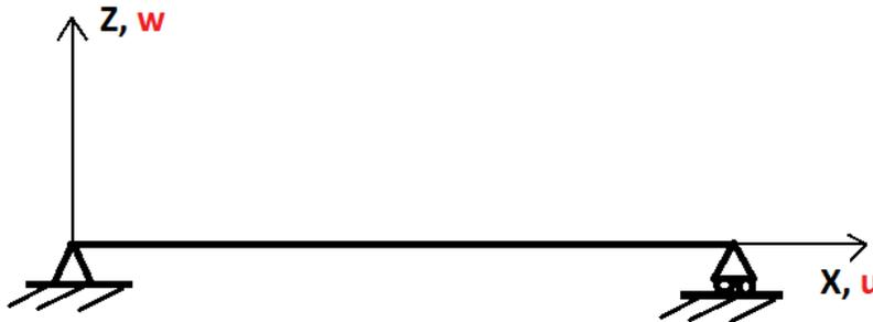
Figura 3.2: Modelo de viga biapoyada
