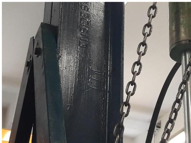
Figura 4. Detalle de la unión del patín con el marco de carga
