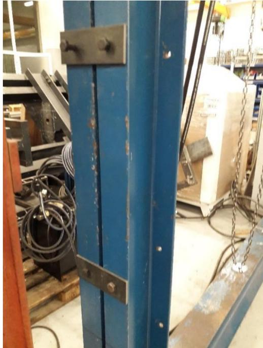
Figura 2. Detalle de la unión de los perfiles
