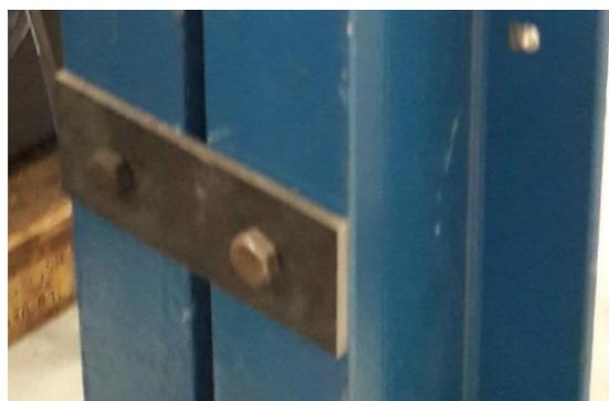
Figura 18. Detalle de la unión de los perfiles mediante las presillas y tornillos
