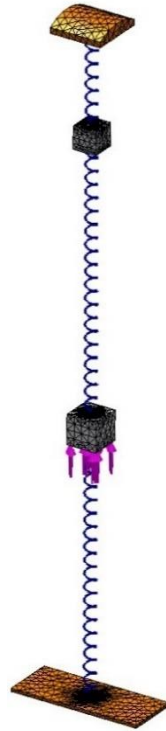
Figura 10.19: Modelo FEM del pantógrafo P1
