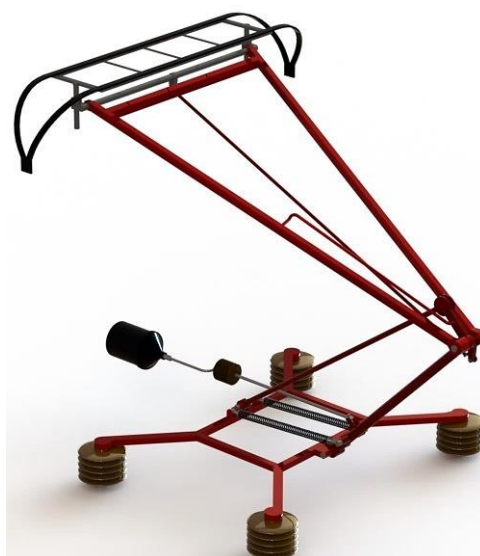
Figura 9.12: Modelo CAD renderizado pantógrafo A1
