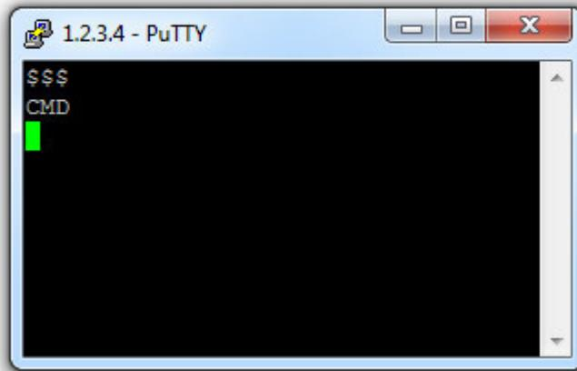
Fig. 65: Modo comando del módulo RN171XV.
