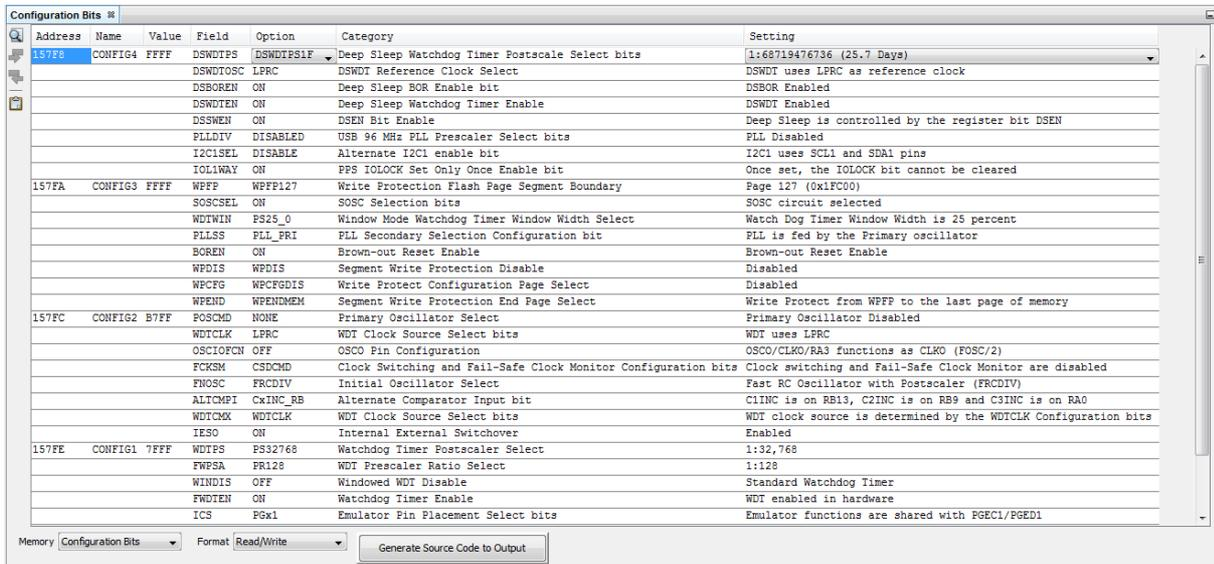
Fig. 59: Ventana de bits de configuración en MPLAB X
