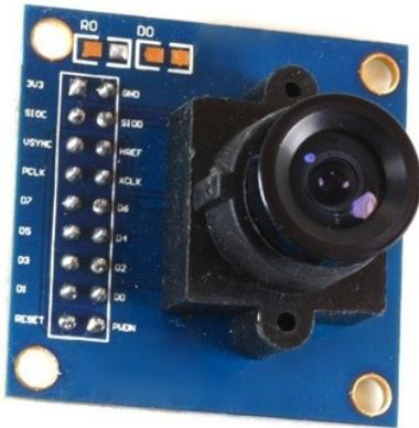
Fig. 6: Cámara CMOS OV7670 [Ele,www].
