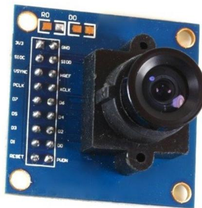
Fig. 12: Cámara CMOS OV7670 [Ele,www].
