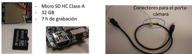
Figura 5: Componentes para el acceso a datos y alimentación (micro USB)
