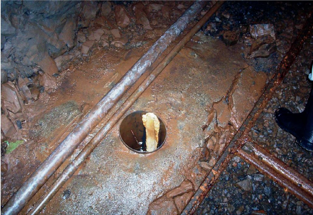
Figura 5.16.- Piezómetro en la traza de la galería.
