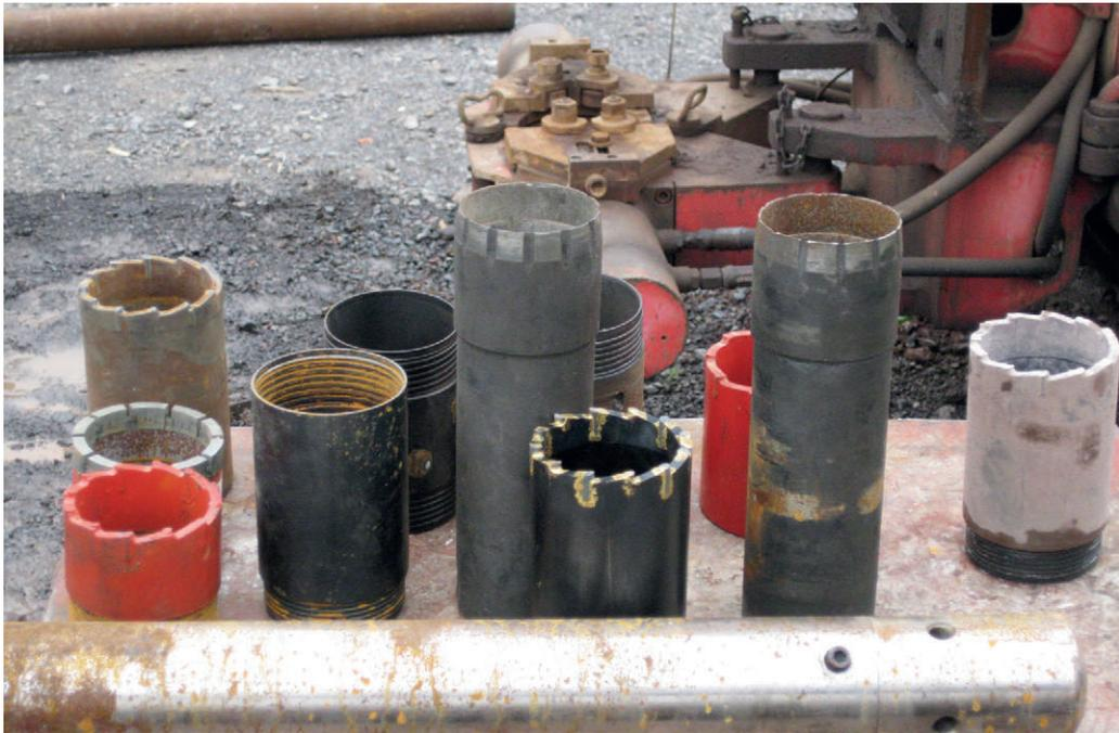
Figura 4.7.- Diferentes coronas para la ejecución del sondeo.
