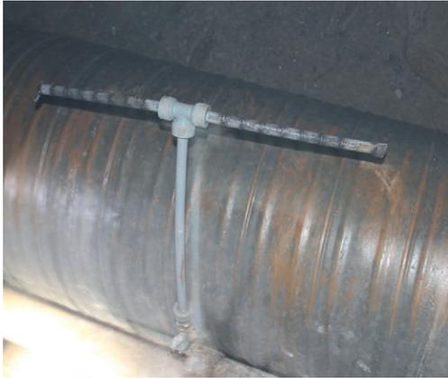
Figura A.16.- Grifo de aire comprimido a lo largo de la traza de la mina.
