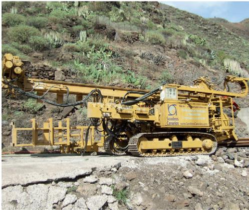
Figura 5.6.- Máquina para la ejecución de sondeos.
