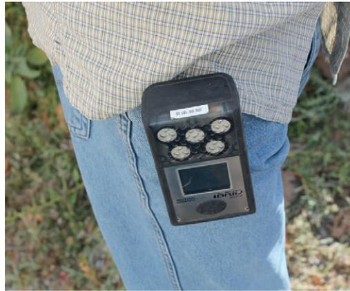
Figura A.15.- Medidor personal de gases en la mina.
