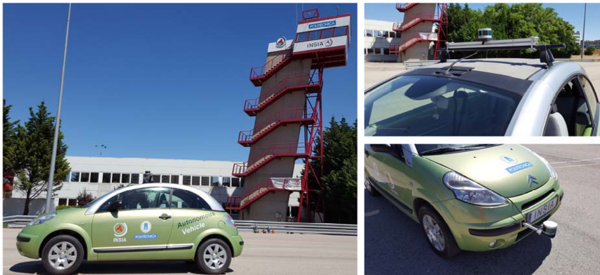
Figura 1. Ubicación del sensor Velodyne VLP 16 en el vehículo autónomo de INSIA
