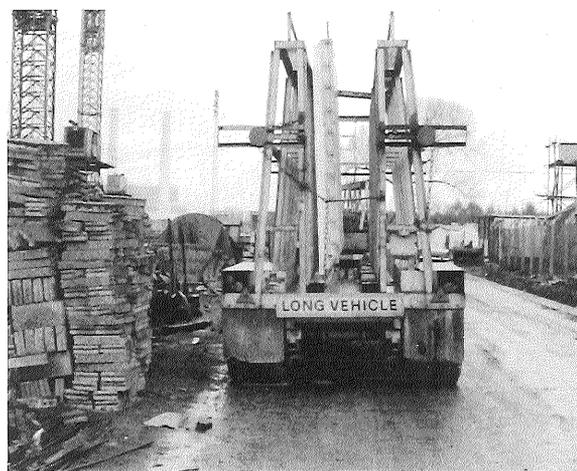
Figura 6.19.- Vehículo normal preparado con un «pupitre en A» para el transporte de grandes elementos. (Figura J. Salas).
