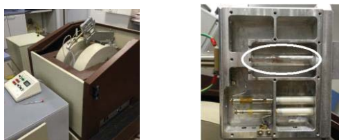
Figura 3. Equipo: relajómetro de ciclado rápido de campo de resonancia magnética y su antena
