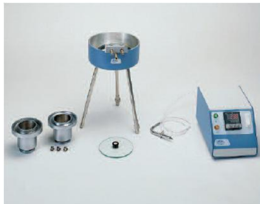
Copas para calefacción con rosca en la base para ser acopladas a baño maría y regulador de temperatura Electemp.
