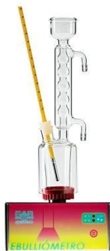
Ebullómetro completo para determinar el grado alcohólico
