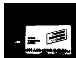
Fig. 8. Ejemplo de reconocimiento de color rojo una vez eliminados los objetos de menos de 300 pixeles.
