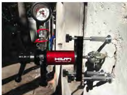
Figura 4 – ensayo de extracción del cáncamo
