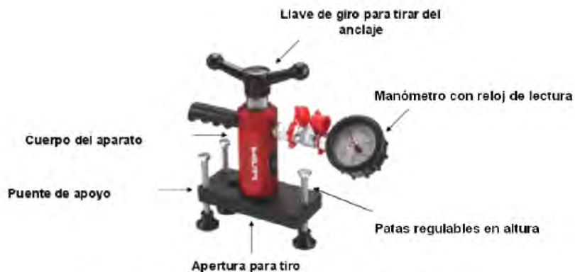
Figura 3 – elementos principales del tester HILTI 28M
