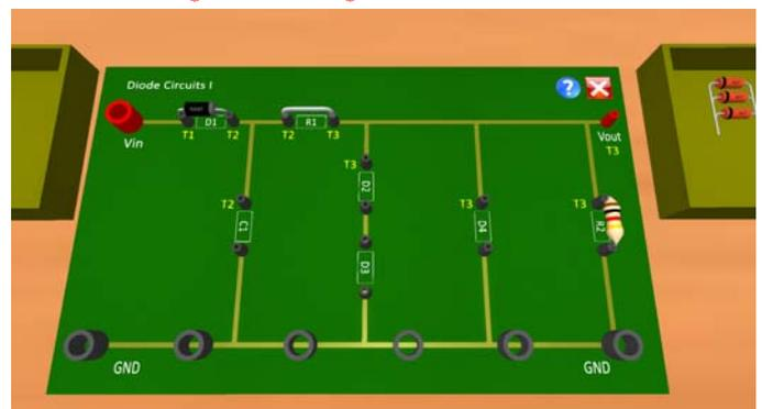
Fig. 4. Circuito rectificador de media onda
