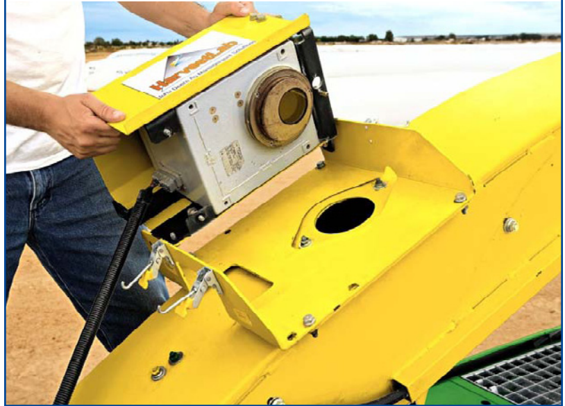
Imagen 5. Sensor HarvestLab basado en tecnología NIRS en una picadora John Deere.
