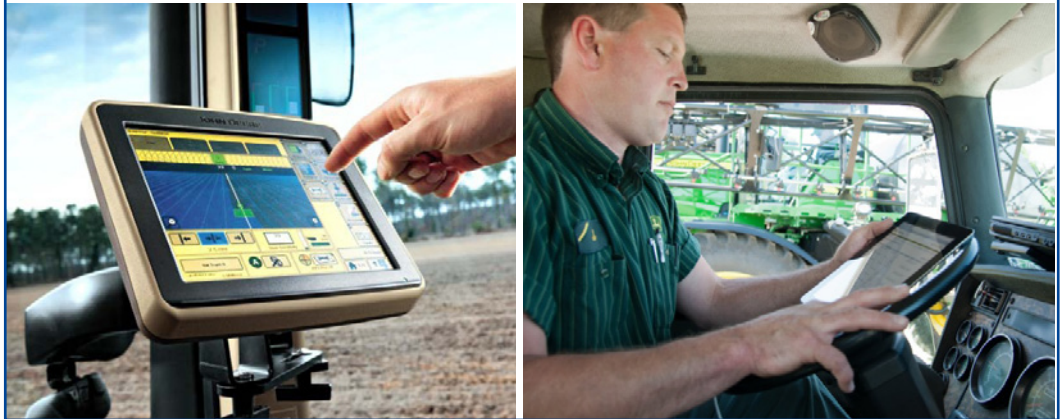
Imagen 2. Monitor ISOBUS en máquina trabajando en campo (izquierda) y visualización mediante el sistema de acceso remoto RDA de John Deere (derecha).
