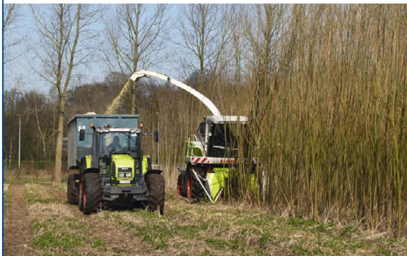
Imagen 6. Picadora de forraje Jaguar de CLAAS cosechando un cultivo de sauce de corta rotación para biomasa (fuente: CLAAS).
