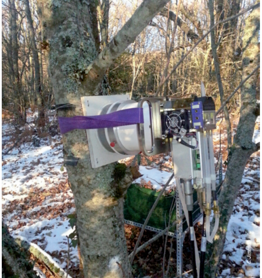
Foto 3. Posición del equipo durante la medida de emisión de \text{CO}_2
