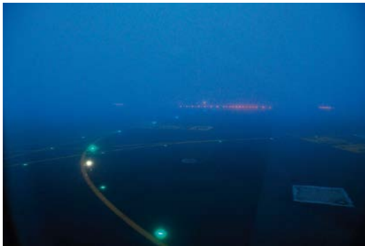
Luces de eje de calle de rodaje, salida rápida, en condiciones de niebla.
