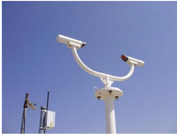
Transmisómetro con una línea base. Esquema de transmisómetros con doble línea base.
