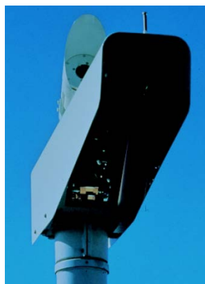
Unidad de transmisómetro con el sensor de luminancia en su parte superior
