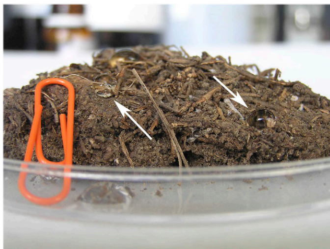
Figura 12.5: Mantillo altamente repelente al agua presente en algunos Andisoles. Véase como las gotas de agua colocadas en su superficie no infiltran en la estructura
