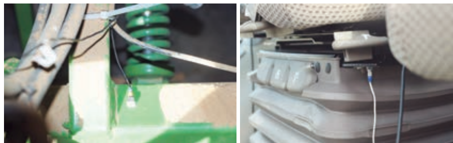
Detalle de la colocación de los acelerómetros en el bastidor del apero (izquierda) y en el asiento neumático con control activo del conductor (derecha).
