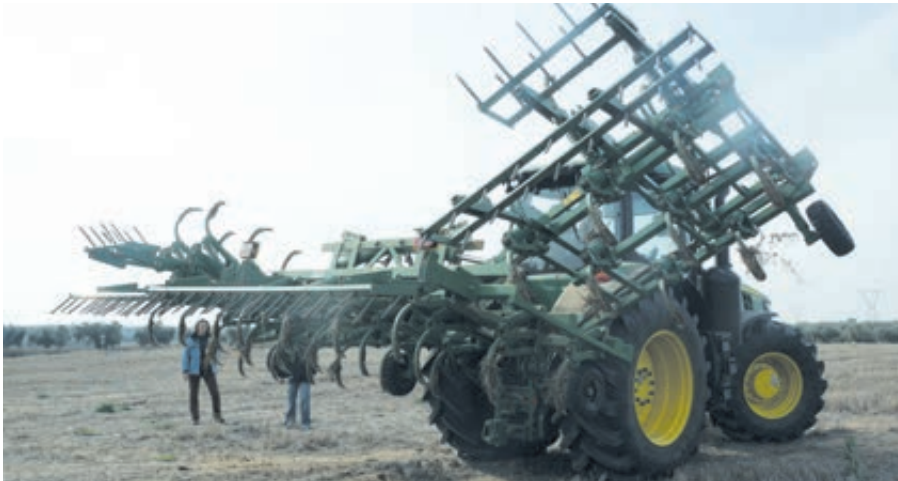
Despliegue hidráulico del chisel de 9 metros empleado en la prueba de campo.
