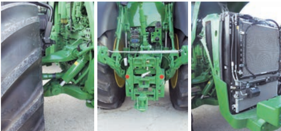
Detalles del tractor 8245R: suspensión delantera (izquierda), opciones a la barra de tiro y mando externos (centro), accesibilidad a radiadores (derecha).
