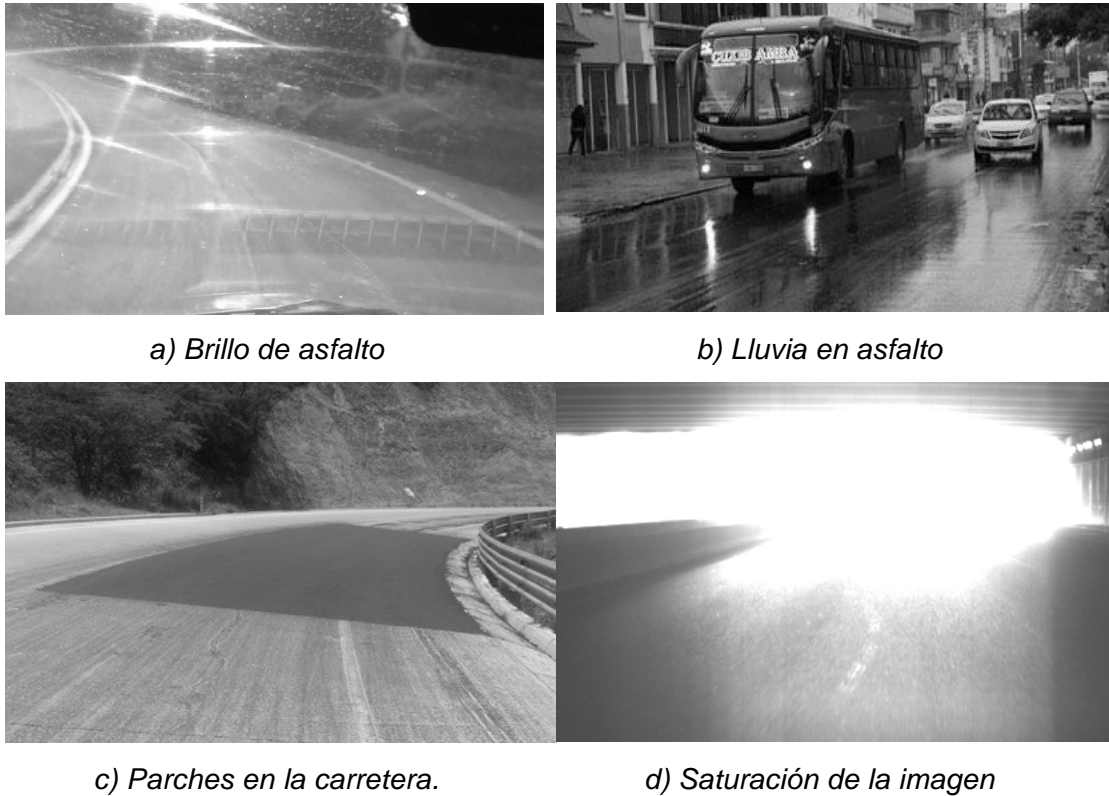
Figura 3.4: Dificultades en la líneas de la carretera (III).
