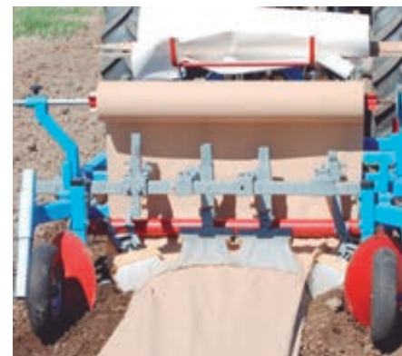
Dispositivo convencional (rodillo, izquierda) y adaptado (cepillo de nylon, derecha) para la aplicación mecanizada de papel con tratamiento adecuado al efecto.
