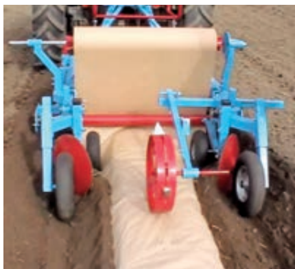
Dispositivo convencional (rodillo, izquierda) y adaptado (cepillo de nylon, derecha) para la aplicación mecanizada de papel con tratamiento adecuado al efecto.
