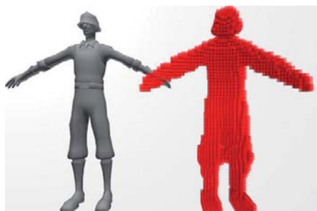
FIGURA 6. Resultado del proceso de voxelización de un objeto OBJ (Véase Ref. 9).
