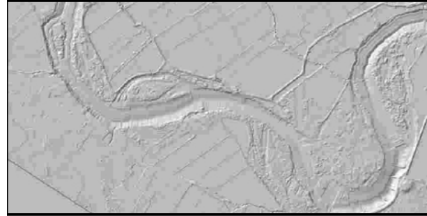
FIGURA 8. Aplicación de LiDAR en el análisis del desarrollo de islas y barras de sedimentación (Fuente: elaboración propia).
