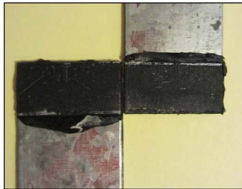
**Figura 3.** Acero Galvanizado con un 98 % de rotura cohesiva.
