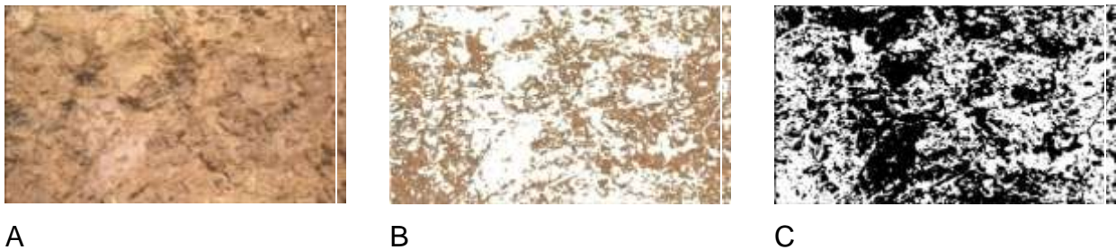
Figura 3.1 Imágenes resultantes de la imagen original y de la imagen suavizada con filtro de ventana 9x9 (A); segmentadas aplicando el algoritmo de umbralización en RGB, de la suavizada (B) y de la suavizada (C).
