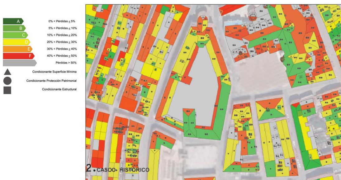
Fig. 2 Plano del detalle del centro de la ciudad de Vitoria-Gasteiz donde los colores muestran la capacidad para generar energía solar fotovoltaica los diversos faldones y azoteas de las edificaciones. Fuente: Trabajo IES-UPM Estefanía Caamaño y Ester Higuera (2013).
