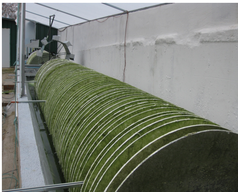
Figura 7. Fotobiorreactor rotatorio de eje flotante, existente en las instalaciones del Grupo de Agroenergética de la UPM, que funciona como planta piloto. El sistema tiene un total de 64 discos de 1 m de diámetro aproximadamente. Al fondo se aprecia la rueda hidráulica motriz (propulsor hidrobárico).
