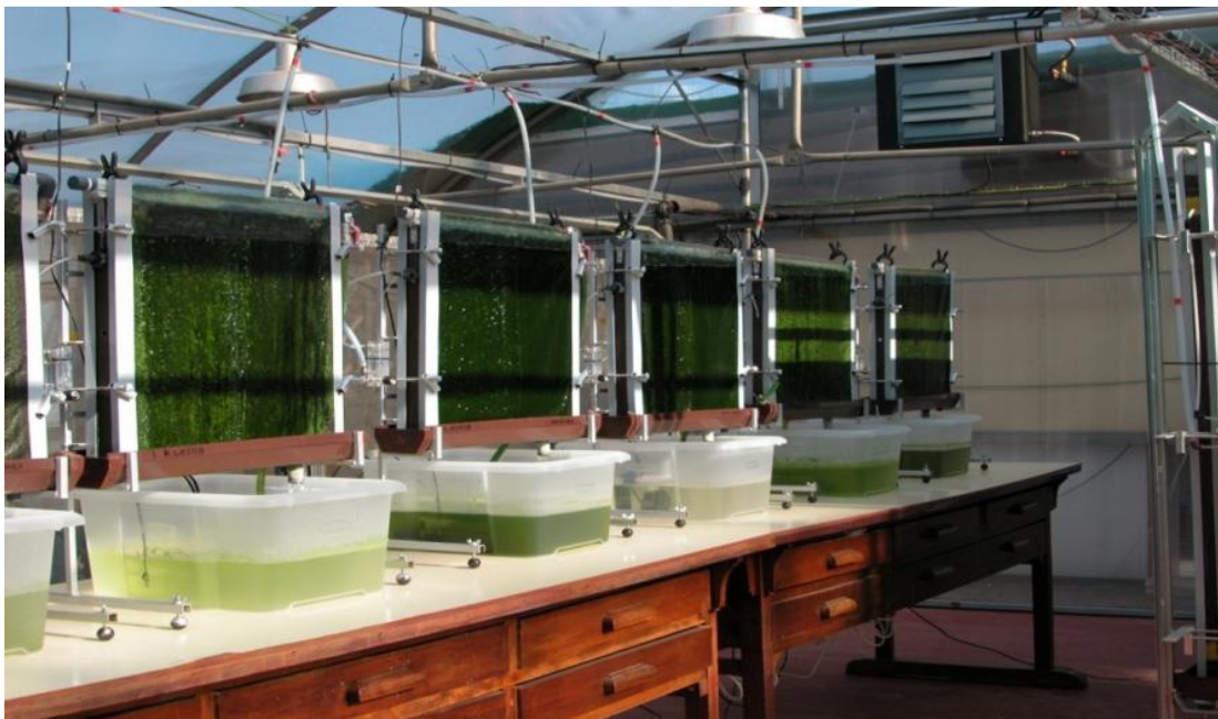
Figura 3. Visión de conjunto de la batería de los 6 PBR experimentales en los laboratorios del Grupo de Agroenergética de la UPM
