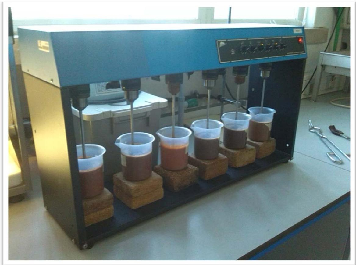
Figura 4.4.5. Mezcla de la muestra con la solución dispersante.
