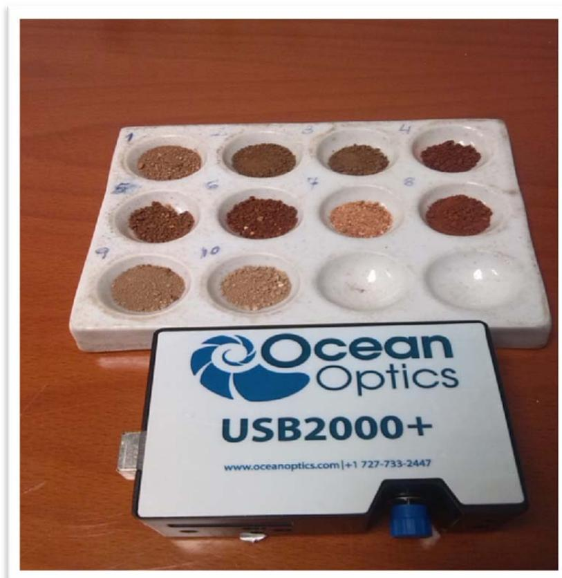
Figura 4.2.2.3 Espectrómetro fibra óptica USB+2000 y muestras para su estudio
