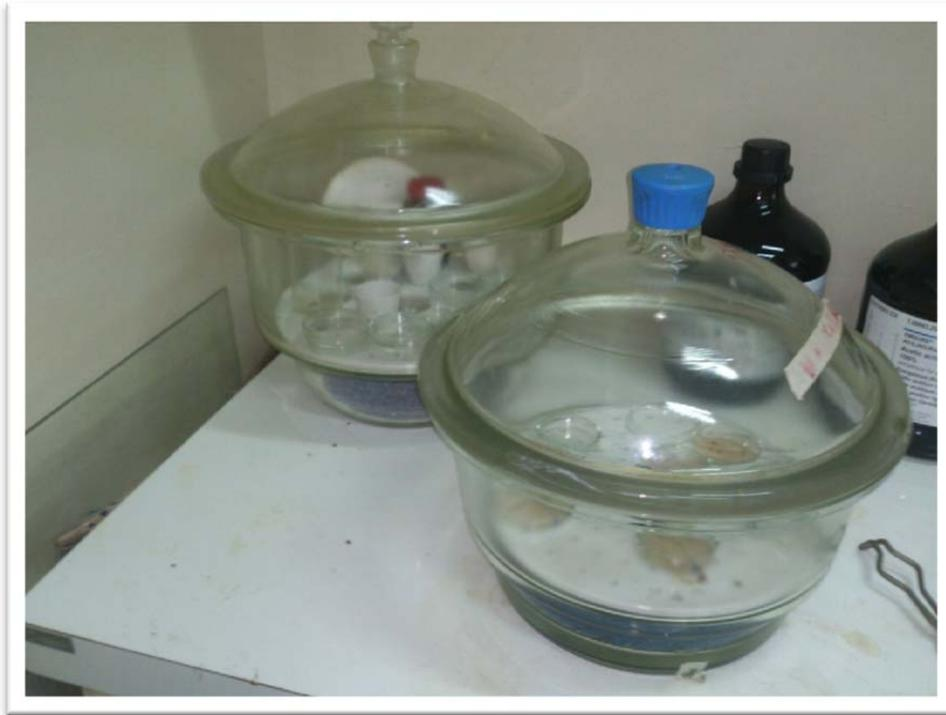
Figura 4.4.2 Desecador empleado en el tratamiento de las Muestras
