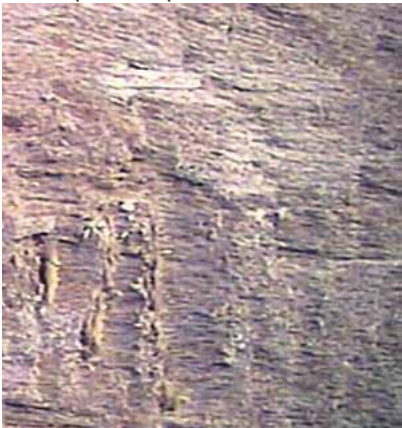
Foto nº14: Detalle del repelo en madera de haya aumentado (lupa 6,3, escala 1/2)
