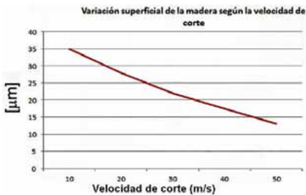
Esquema nº 3: Variación de la rugosidad superficial según la velocidad de corte
