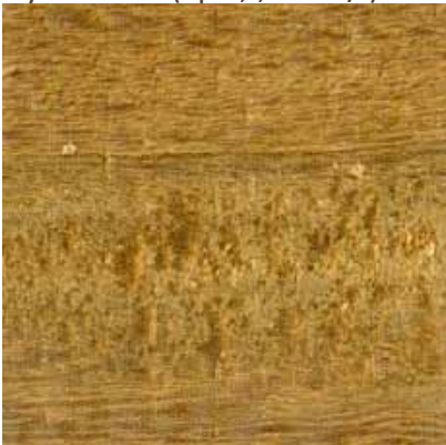
Foto nº15: Repelo en madera con la fibra entrelazada (escala 1:2)
