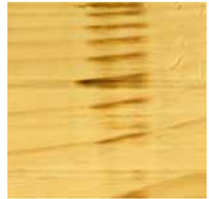
Foto nº18: Aspecto de quemadura por herramienta (escala 1:2)
