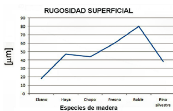
Esquema nº 4: Variación de la rugosidad superficial según el grano de la madera
