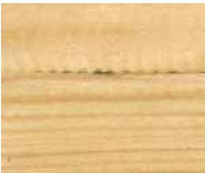
Foto nº4: Marcas de cuchillas provocadas por una cepilladora (escala 1,5:1)
