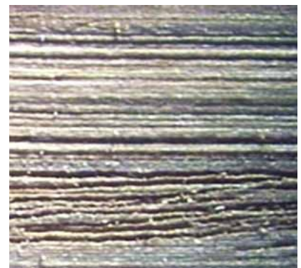
Foto nº6: Aspecto aumentado de la superficie de fresno trabajada con cuchilla (lupa 6,4 aumentos, escala 1/2)
