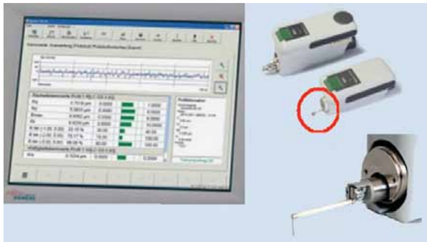
Foto nº11: Perfilómetro mecánicos de la rugosidad superficial (Mahr Metrology)
