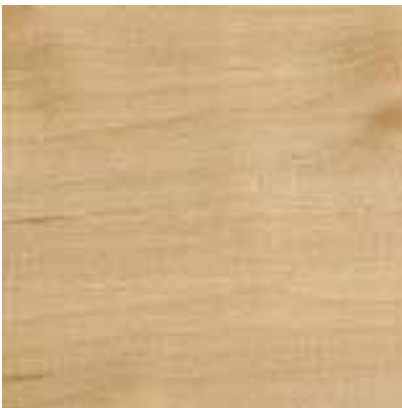
Foto nº13: Repelo en madera de haya debido al nudo (escala 1:1)
