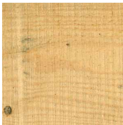
Foto nº1: Marcas de dientes producidos por una sierra de banda (escala 1:4)
