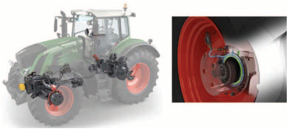
Figura 4. Esquema del sistema VarioGrip de Fendt para regulación de la presión de los neumáticos. Fuente: Fendt.
