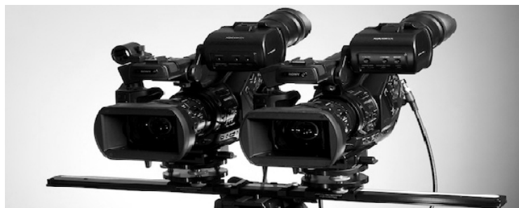
FIGURA 2.6 – Rig estéreo: configuración de cámaras en paralelo [44]
