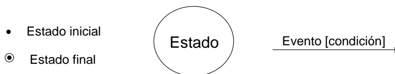
Figura 2.5 Notación de los Diagramas de Transición de Estados
