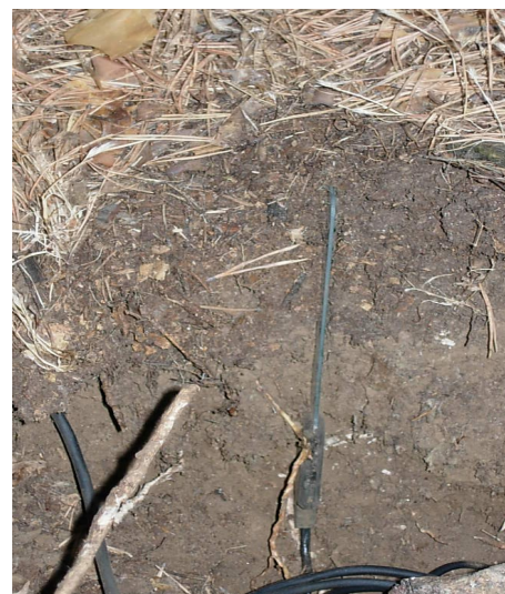
Figura II.11: Sensor de humedad colocado verticalmente en los 10 primeros cm de profundidad (Foto: V. Gómez)
