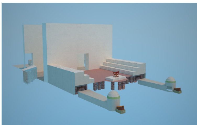
Hipótesis del interior de la Curia y el sistema de calefacción.
