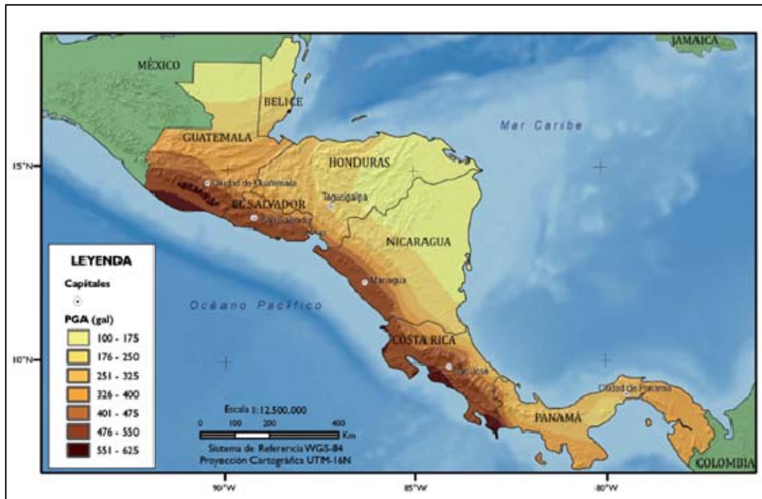
Figura 7.- Mapa de amenaza sísmica en América Central en términos de PGA (gal) para PR = 500 años (Benito y Torres, 2011).
