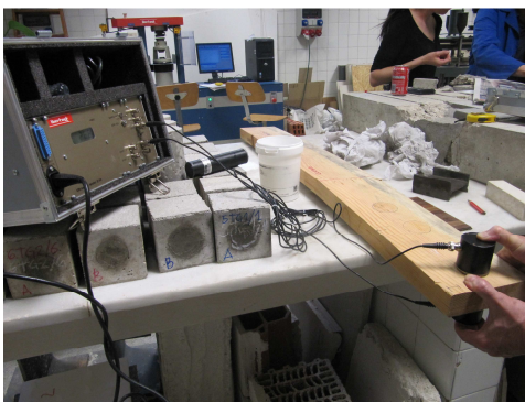
Figura 1- Ensayos con Ibertest Ultrasonic Tester E46.
