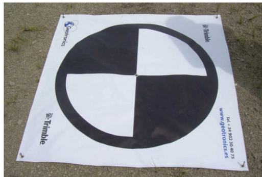
Ilustración34. Lona utilizada para marcar los puntos de apoyo
