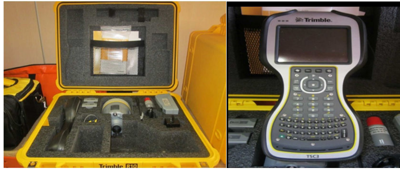
Ilustración 16. Equipo GNSS Trimble. Receptor R10 y controladora TSC3
