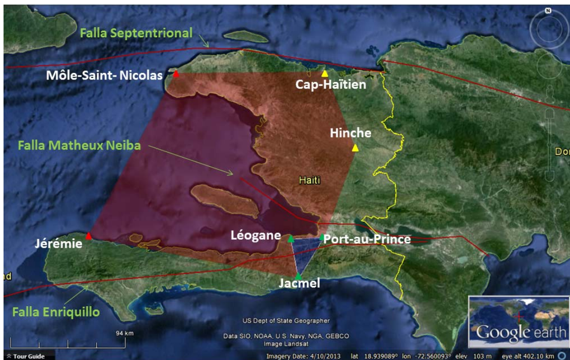
Figura 30. La cobertura de la red con las 4 nuevas estaciones Libra II en Jérémie, Môle Saint Nicolas, Cap Haitien e Hinche. Los triángulos verdes son estaciones de la RNC, los amarillos son del ONEV y no son configuradas y los rojos son sitios elegidos todavía las estaciones no se han instalado.
