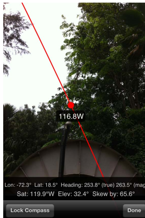
Figura 16. Mala visibilidad de SATMEX5 desde la estación de Puerto Príncipe. El punto rojo indica la posición del satélite en programa de realidad aumentada para iPhone “Dish Pointer AR”
