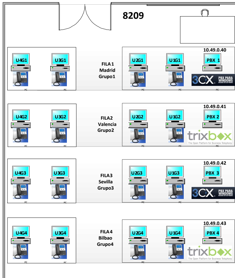
Ilustración 62. Esquema de la red del módulo 8209
