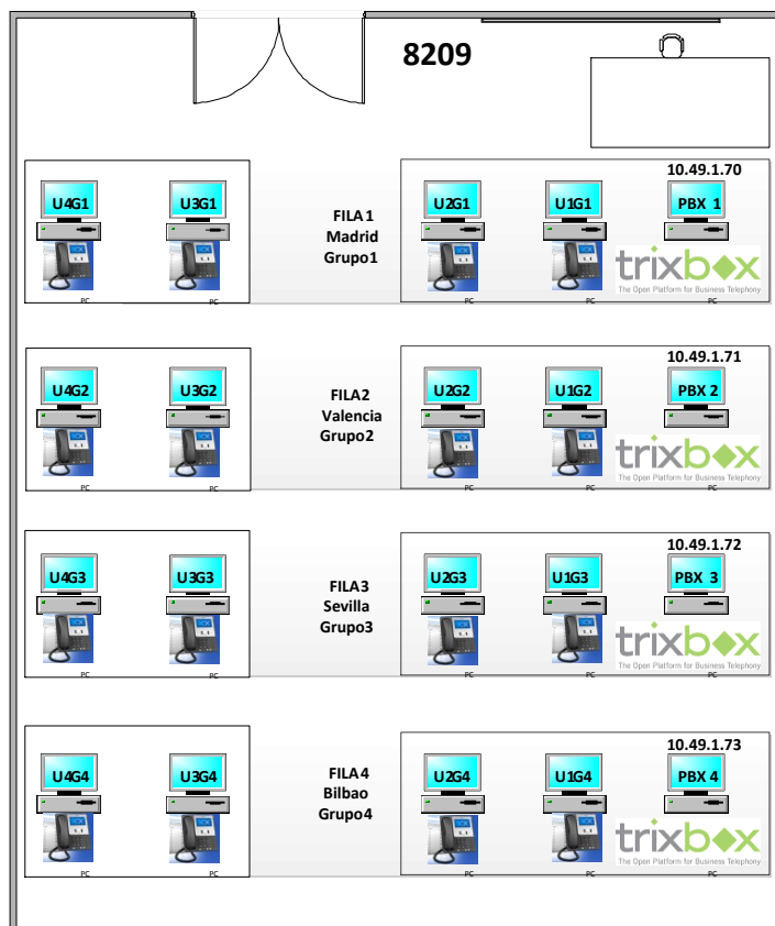
Ilustración 49. Esquema de la red del aula 8209
