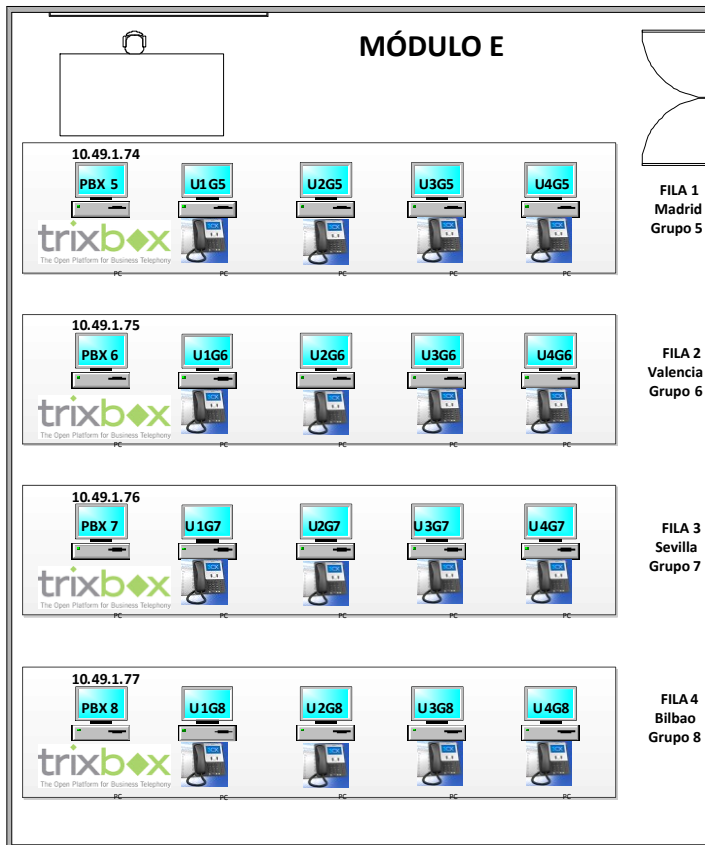
Ilustración 48. Esquema de la red del módulo E
