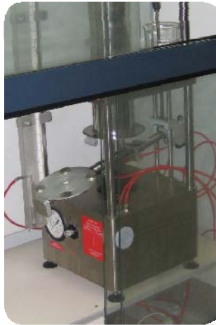
aplicación con Torre de Potter residuo medio: 1,5-2 mg/cm 2 (1 ml; 50 kPa)
