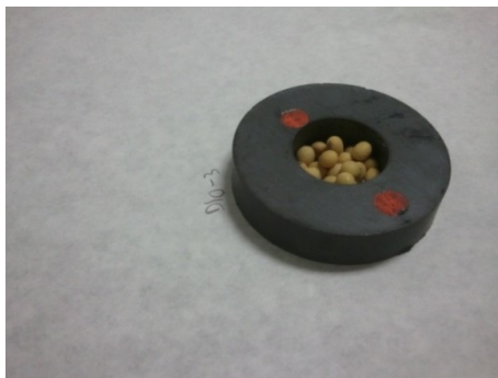
Fotografía 2 Grupo de 25 semillas de soja en el hueco de un imán para recibir tratamiento magnético.
