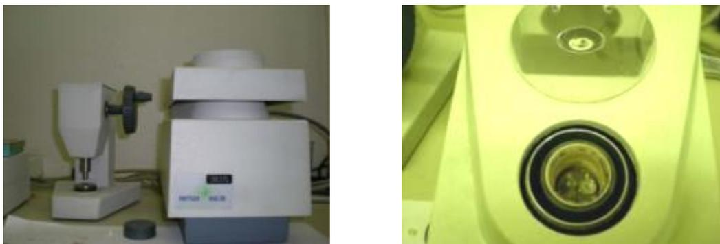
**Figura 46: Equipo de calorimetría diferencial de barrido**
