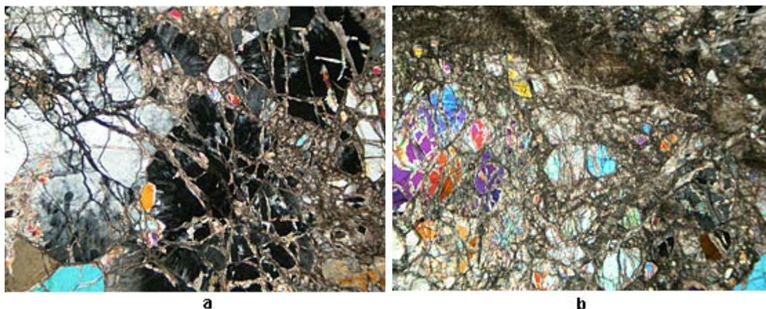
Figura 6 (a y b): microfotografías de una serpentinita alterada por procesos hidrotermales muy cerca del contacto con las andesitas.
