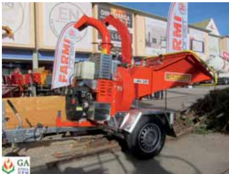
Astilladora (biotritrador) BIO 230 Caravaggi para reducción del tamaño de partícula de distintos tipos de biomasa leñosas (recomendación de diámetros de ~10 cm), en Expobiomasa 2014.
