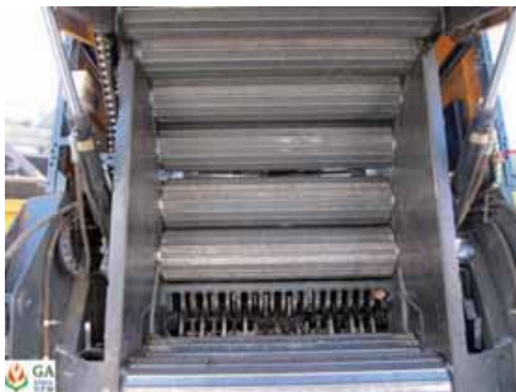
Biobaler WB-55: detalle de la cámara de empacado.
