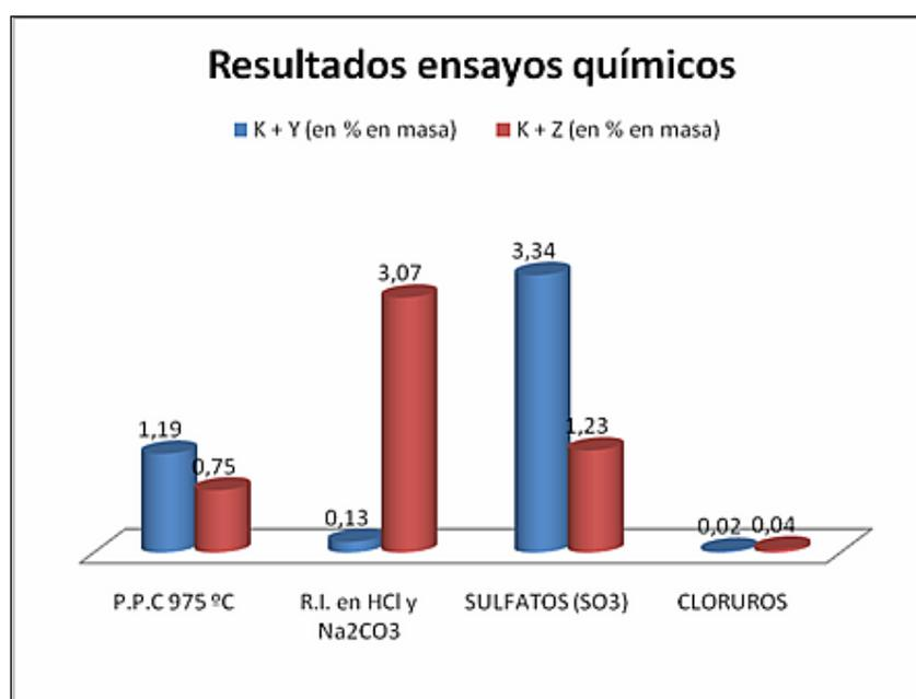
Figura Nº 20: Representación gráfica de los resultados del análisis químico de las mezclas (K+Z) y (K+Y). (K+Z)<sup>1</sup> / (K+Y)<sup>2</sup>: 1 Clínker + zeolita; 2 Clínker + yeso (cemento de referencia) (Fuente: Aranzazu, M., *et. al*, 2011).
