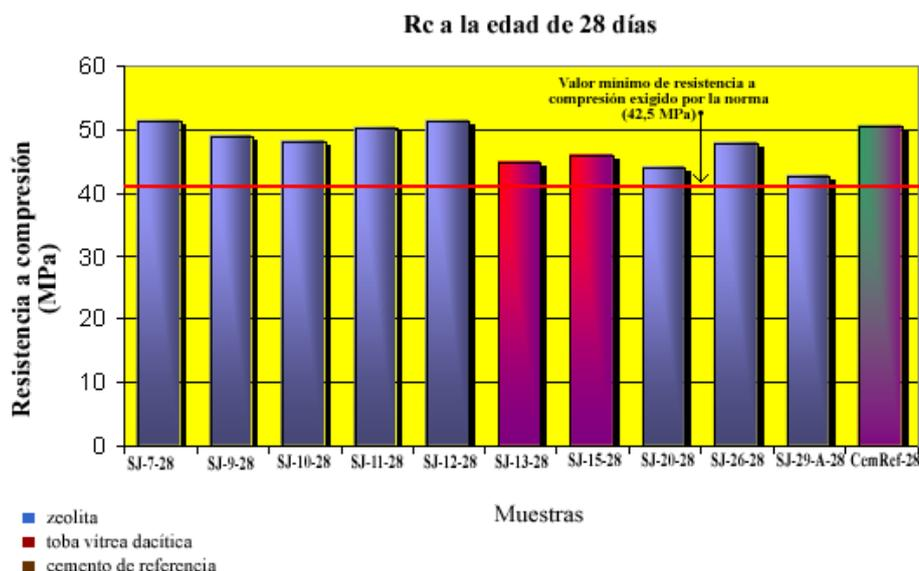
Figura Nº 16: Comparación de los valores de resistencia mecánica a compresión correspondiente a las muestras de morteros con puzolana natural y al cemento de referencia para la edad de 28 días (Fuente: Costafreda, J.L., 2008).
